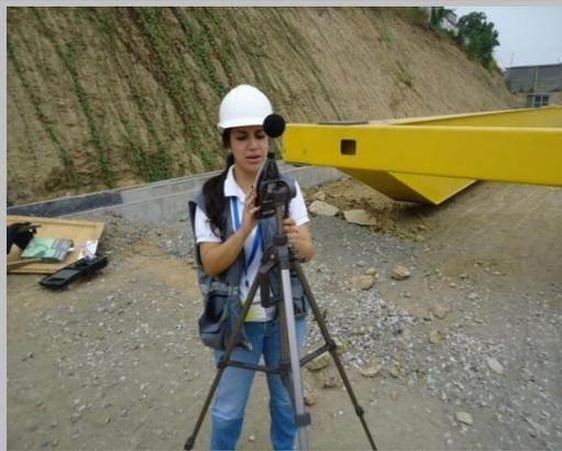
Fotografía 3 y 4.- Instalación y ubicación del sonómetro en el trípode, estación EAR 1.
