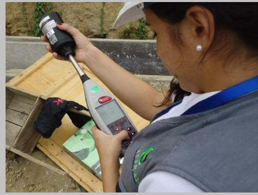
Fotografía 1 y 2.- Calibración del sonómetro
