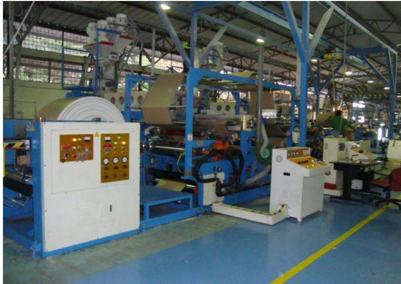
**Figura 8.** Laminadora Axiplast. Información obtenida de Sacos Duran ReySac S.A. Departamento de Mantenimiento. Elaborado por el autor
