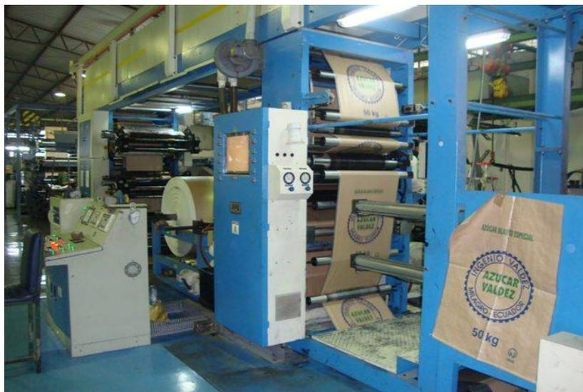
**Figura 9.** Impresora rotativa Axiplast. Información obtenida de Sacos Duran ReySac S.A. Departamento de Mantenimiento. Elaborado por el autor
