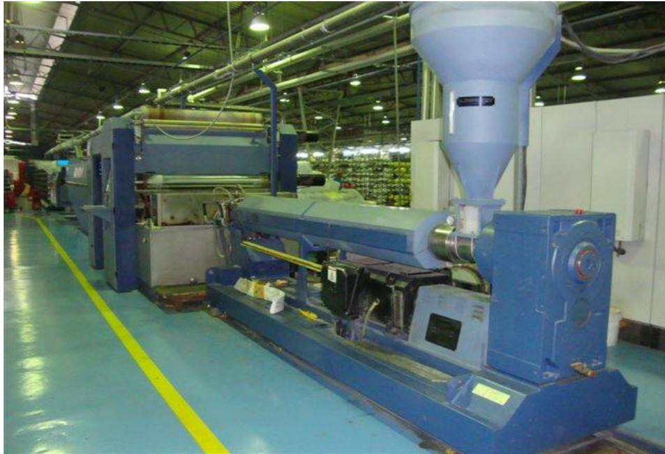
**Figura 6.** Extrusora plana. Información obtenida de Sacos Duran ReySac S.A. Departamento de Mantenimiento. Elaborado por el autor
