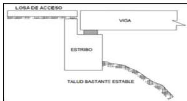
**Ilustración 14:** Estribo tipo “silleta”
