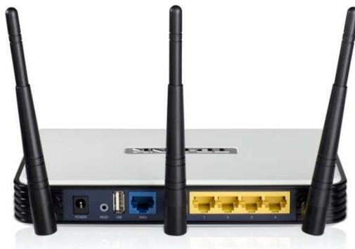
Conectar el adaptador de energia al equipo y conectar este hacia la computadora por medio del cable de red en un puerto LAN del TP-link. Cconfigurar en la computadora una IP en la tarjeta de red que debe estar en el rango de la 192.168.100.x con mascara de 255.255.255.0
