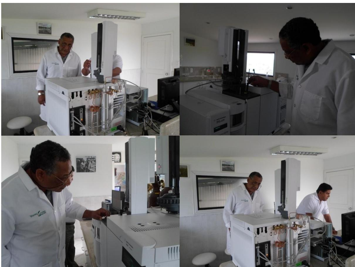
Se tomó 1 ml de muestra que se volatiliza en el equipo y este es llevado mediante un gas (neón, helio, hidrogeno) y este pasa por una serie de columnas cuyo espesor es menor a 1mm pero esta son de aproximadamente 60 metros de longitud, es la columna que determina los componentes presentes en la muestra.
