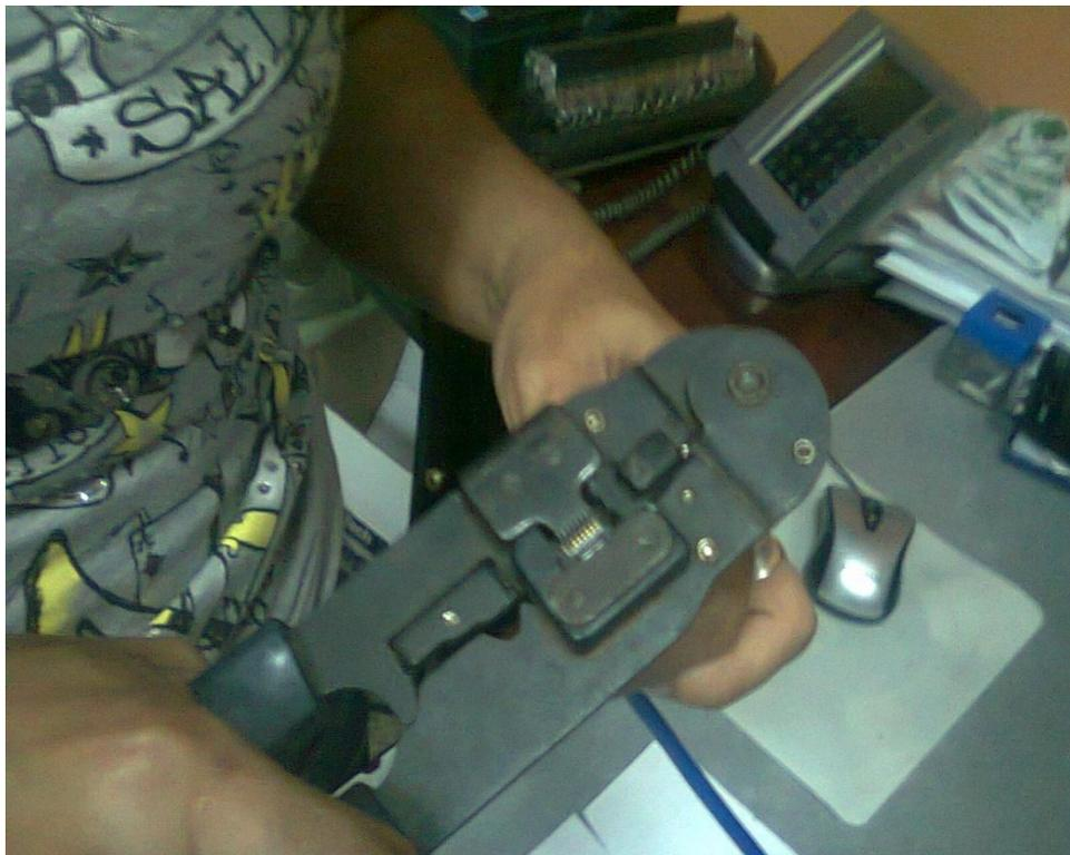
**Ligia Coello en el proceso de instalación, ponchando un conector RJ45**
