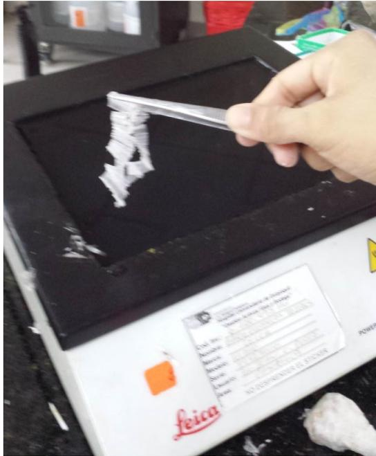
**Figura 30.** Baño Flotación de Tejido Leica.
