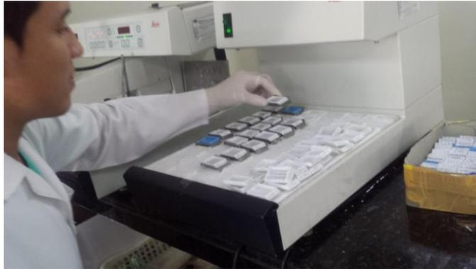
**Figura 28.** Placa Congelante para la Formación Solida del Bloque de Parafina Leica.
