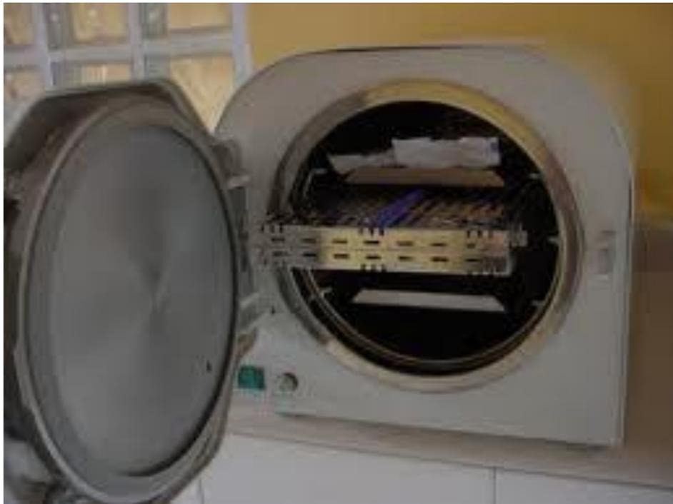
Esterilización por calor húmedo en la odontología, aparato empleado para esterilizar mediante calor húmedo. Se basa en la acción letal del vapor de agua a presión.
