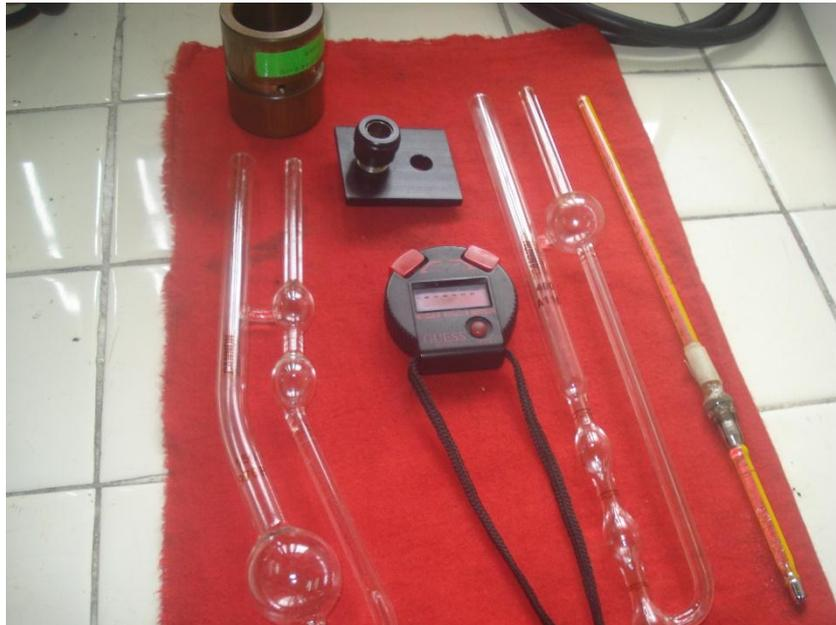
**Figura 13. Materiales de laboratorio para medir la viscosidad**
