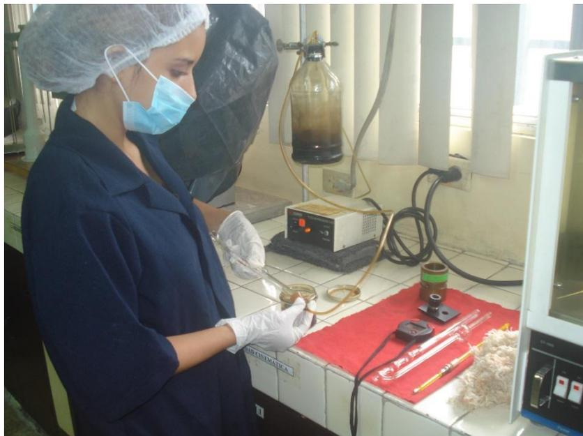
**Figura14. Llenado de aceite en el viscosímetro**
