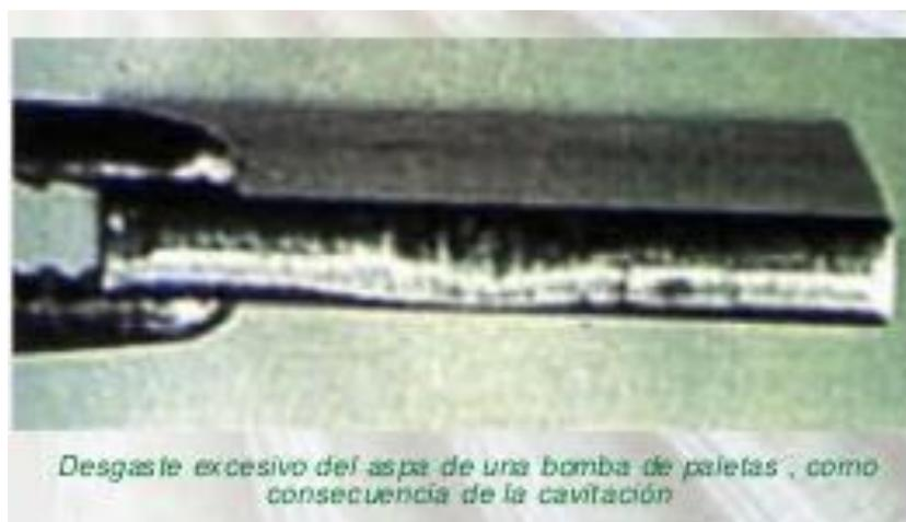
*Figura7. Desgaste excesivo del aspa de una bomba de paletas, como consecuencia de la cavitación.*
