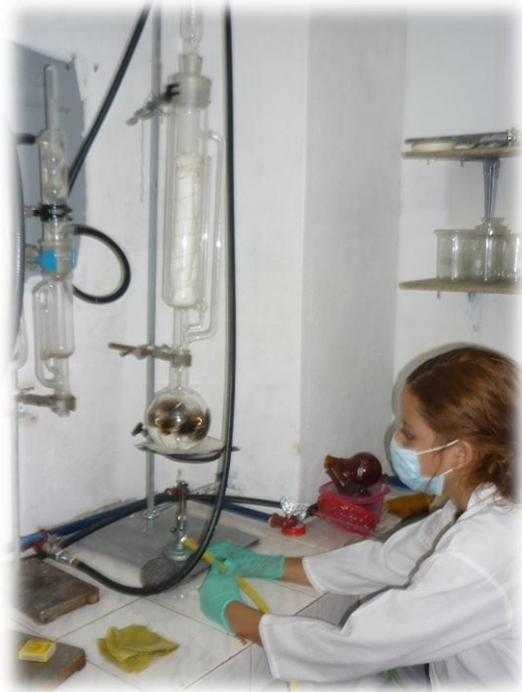
***Figura No.11. Armado del Equipo de extracción Soxhlet***
