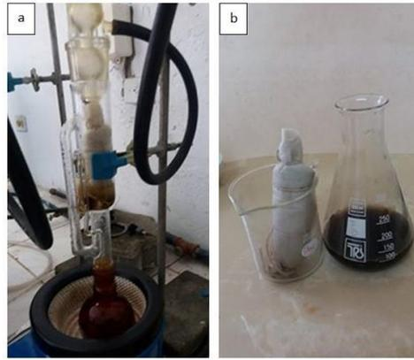
Figura 19. Determinación de extractivos acuosos y orgánicos: a) Cartucho con el raquis de banana montado en el Sistema Soxhlet, b) Cartucho y solución luego de realizar la extracción.
