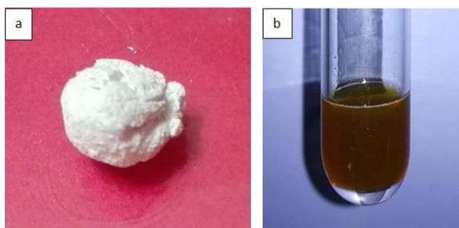
Figura 23. Tratamiento mecánico del raquis de banano: a) celulosa seca luego de ser tratada con  $C_2H_2O_4$ , b) Nanofibras de celulosa y nanopartículas de plata en suspensión luego de la agitación.
