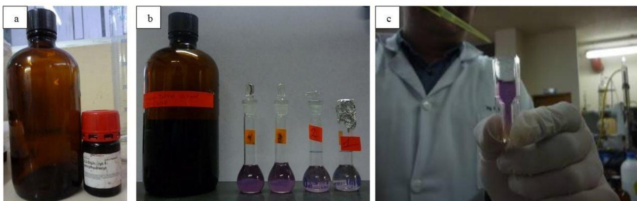
Figura 24. Prueba DPPH: a) Preparación del patrón DPPH, b) Alícuotas de DPPH para calibrar el equipo, c) Cambio de coloración característico de violeta a amarillo.
