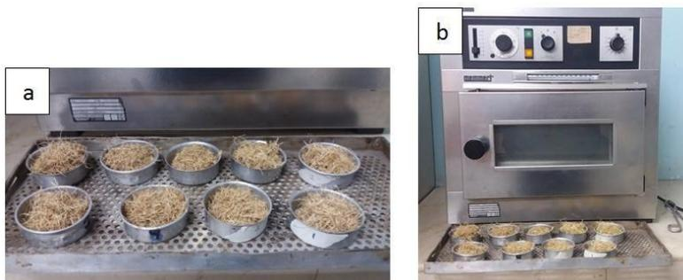
Figura 17. Determinación de Humedad del raquis de banano: a) Muestras de raquis de banano, b) Estufa con las muestras de raquis.
