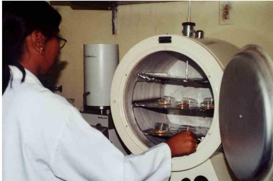
DETERMINACIÓN DE HUMEDAD POR SECADO EN ESTUFA A 105 °C
