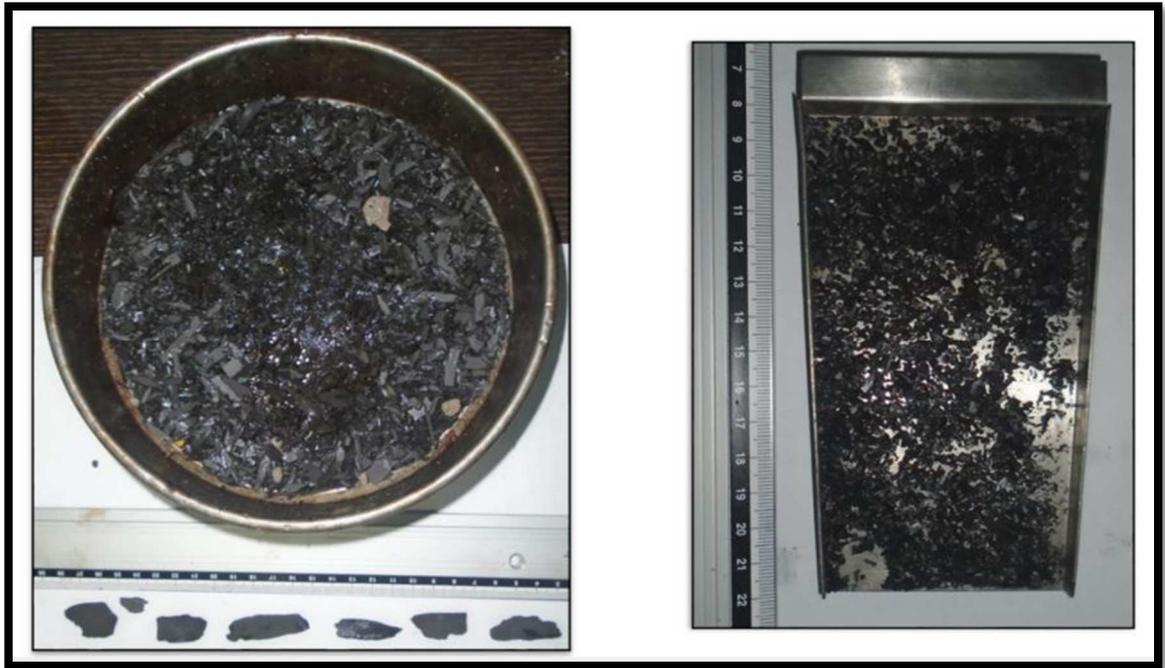
Foto. 3.1 Diferencia entre cortes de perforación (derecha) y cortes retrabajados (cavings > 2 cm). Fuente: Autor.
