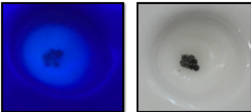
Foto 3.26 Vista del anillo residual con luz ultravioleta (izquierda) y luz natural (derecha) de las muestras de Arenisca manchadas con hidrocarburos en el pozo B2 (1). Fuente: Autor
