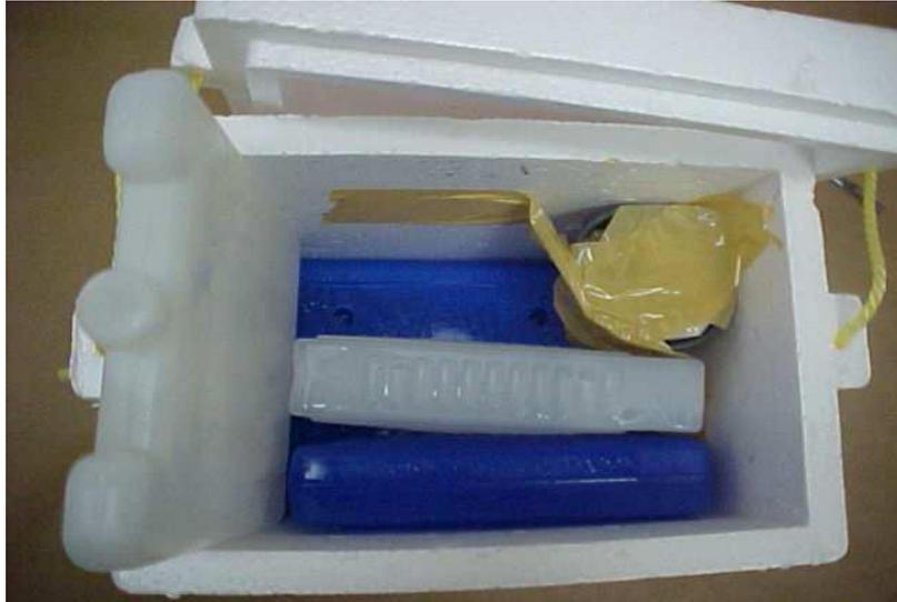
**Figura 3.** Conservación de muestras con gel refrigerante.
