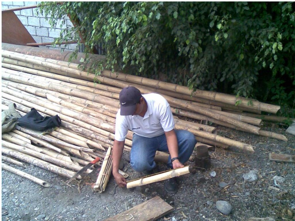
**Foto 3.** Fabricación de la estacas para realizar las muestras.
