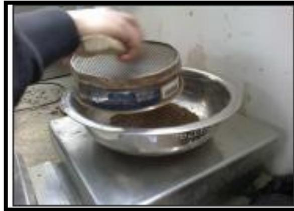
**Ilustración 10:** Tamizado del material del suelo
