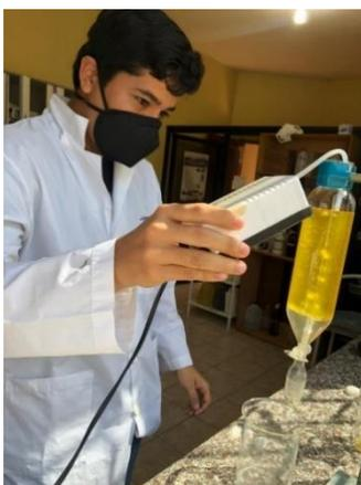
Ilustración 25:Proceso de lavado por aireación del biodiésel
