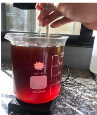
*Ilustración 20: Adición y agitación del metóxido de sodio*
