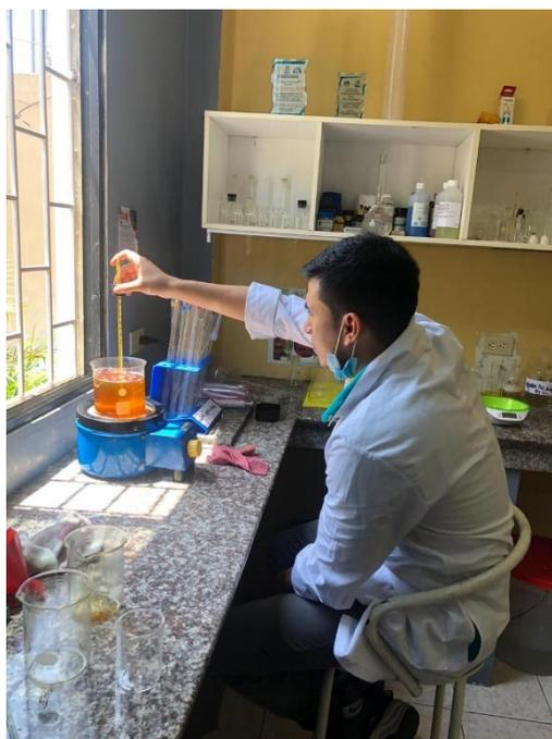
*Ilustración 17: Proceso de secado del Avu en la manta de calentamiento*
