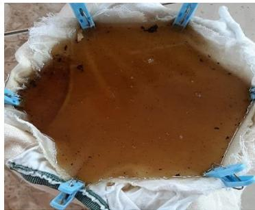
*Ilustración 12: Adición de aceite vegetal usado al sistema de filtrado*
