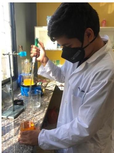
Ilustración 18: Adición de H<sub>2</sub>SO<sub>4</sub> para la reacción de transesterificación
