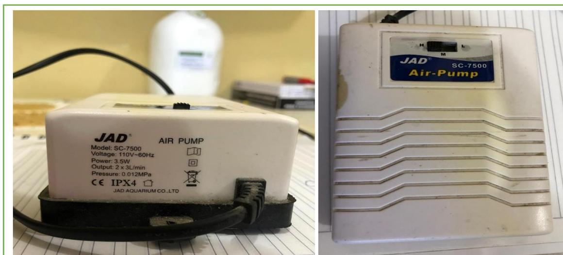
Anexo 6: Aireador utilizado para el sistema de limpieza por aireación
