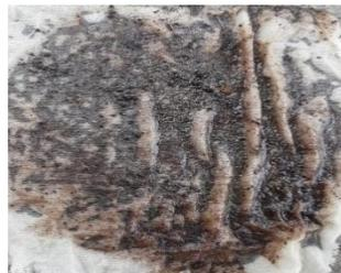
*Ilustración 13: Residuos retenidos en el sistema de filtrado*
