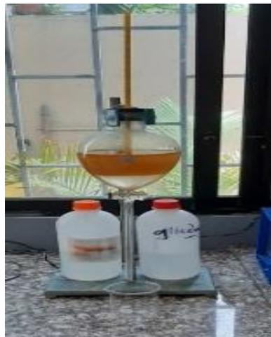
*Ilustración 16: Decantación de Avu-agua destilada*
