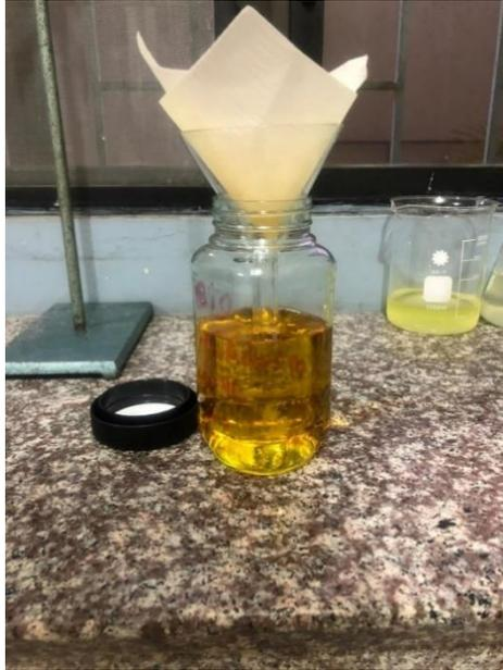
*Ilustración 27:Filtración del biodiésel*
