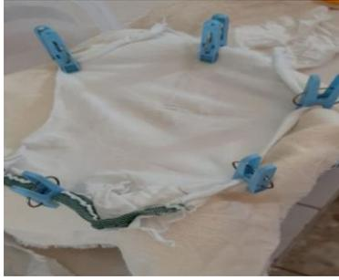
*Ilustración 11: Sistema de telas empleadas para el sistema de filtrado*
