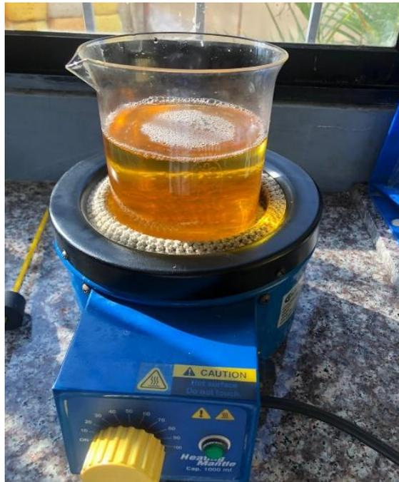
*Ilustración 26:Secado del biodiésel*
