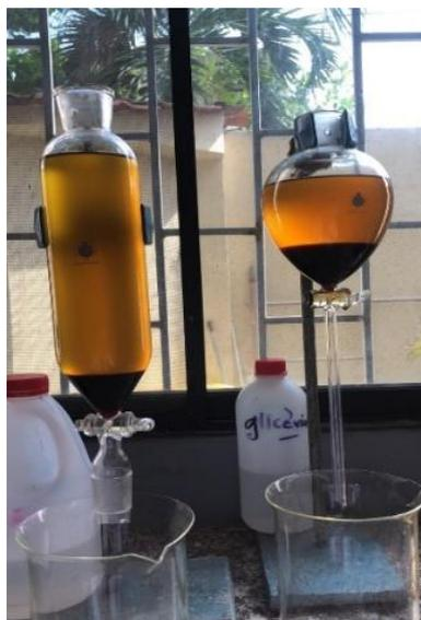
*Ilustración 22: Decantación de la glicerina y el biodiésel*
