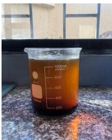
*Ilustración 21: Reposo de la muestra para la separación de la fase de biodiesel y glicerina*
