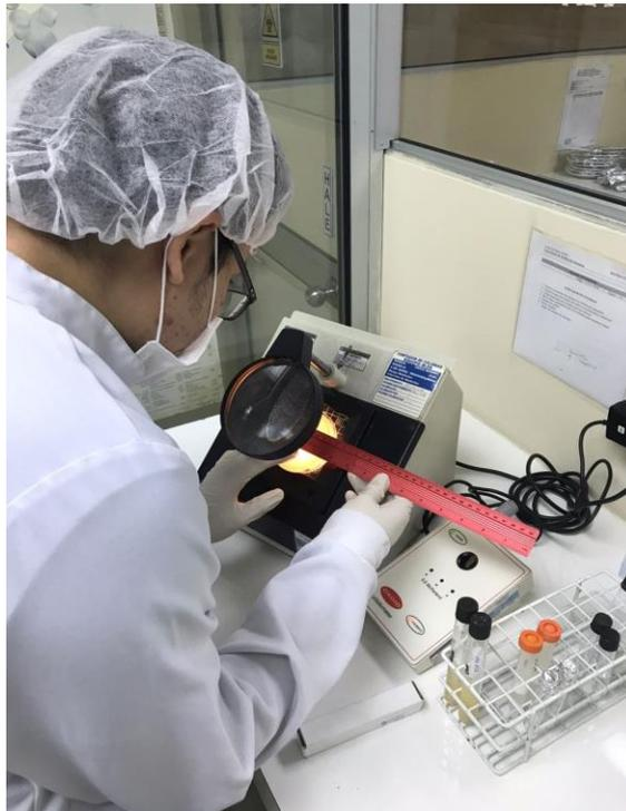
3) Medición de halos de inhibición
