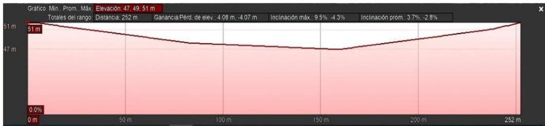
Ilustración 6. Cotitas del terreno de forma transversal.
