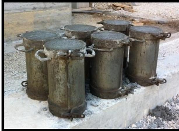
Ilustración #20: Cilindros de Pruebas
