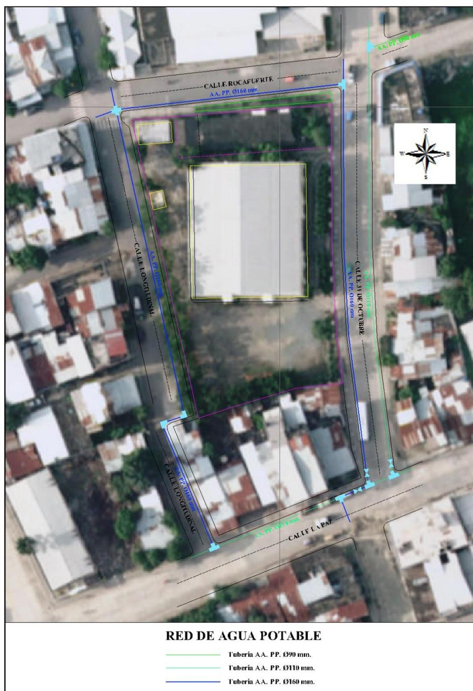
**Ilustración 34. Red de agua potable elaborado por el Autor**
