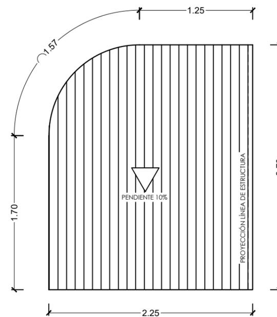
NOTA: CUBIERTA TIPO SÁNDUCHE CON NÚCLEO DE POLIURETANO 30 mm.
