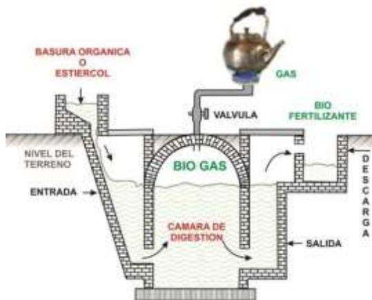
**Figura 18.** Funcionamiento de Biodigestores. Información tomada de puentes digitales. Elaborado por Puentes Digitales.
