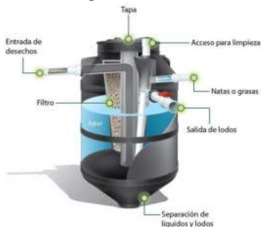
**Figura 13.** Estructura de un Biodigestor. Información tomada de IQR Ingeniería Química, 2020. Elaborado por IQR.
