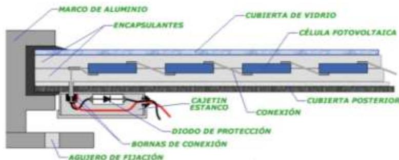
**Figura 30** Partes de un panel solar. Información tomada de (cardenás,2019). Elaborado por Cardenás,2019.
