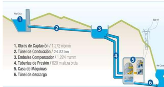
**Figura 12.** Partes de la central Hidroeléctrica Coca Codo Sinclair. Información tomada de CELEP. Elaborado por CELEP.
