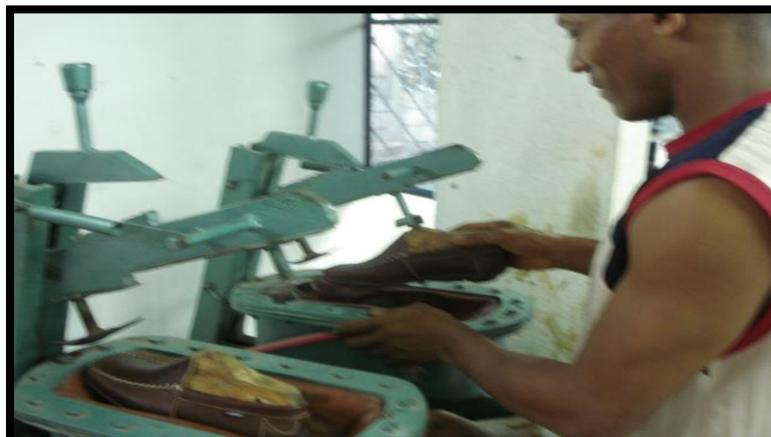
Figura 21 Prensada del calzado
