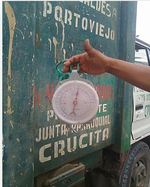
**Fotografía 2. Báscula utilizada para el pesaje de residuos sólidos muestreados**
