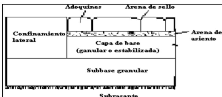
Ilustración 11 Estructura típica de un pavimento articulado
