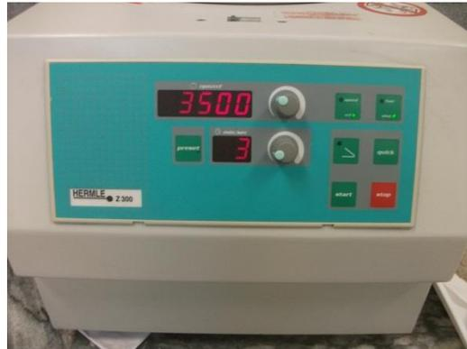
**Se centrifuga a 3500 rpm por 3 min.**
