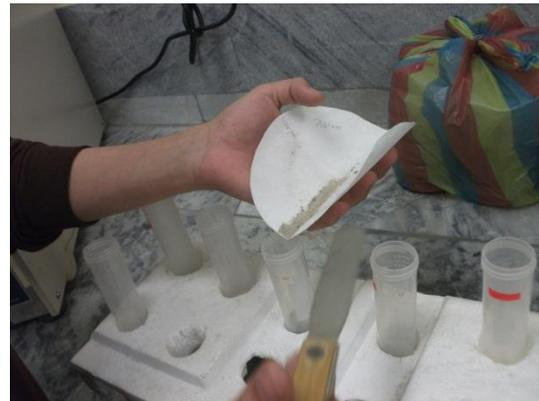
**La muestra se coloca en los tubos para centrifuga**
