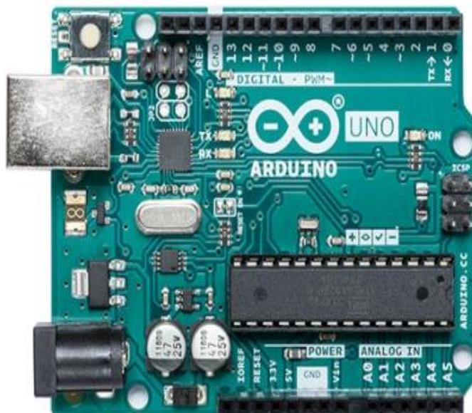
*Figura 12. Placa de Arduino UNO. Información tomada de arduino.cl. Elaborado por el autor.*
