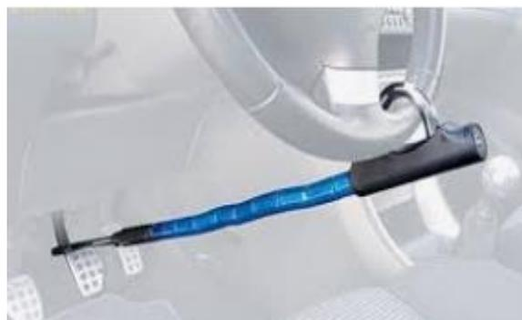
*Figura 3. Barra antirrobo en el volante. Información tomada de repositorio de imágenes de Google. Elaborado por el autor*
