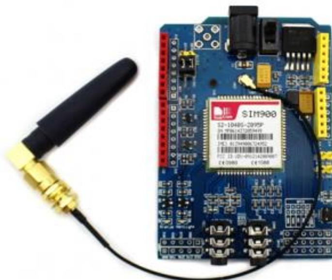
*Figura 13. Módulo SIM 900. Información tomada de carrod.mx. Elaborado por el autor.*
