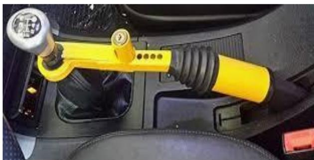
*Figura 2. Bloqueador de freno de mano y la caja de cambio. Información tomada de repositorio de imágenes de Google. Elaborado por el autor*
