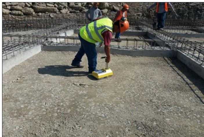
**Figura 32:** Prueba del densímetro nuclear
