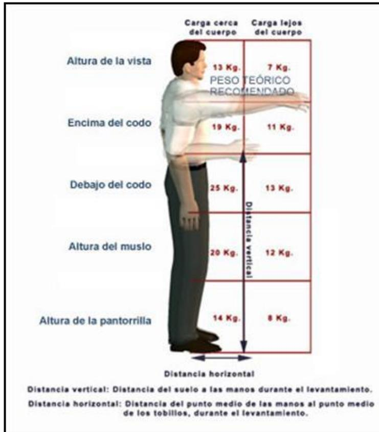
Figura 18. Representación de los posibles valores del Peso Teórico, en función de la zona de manipulación, en condiciones ideales de manipulación.
