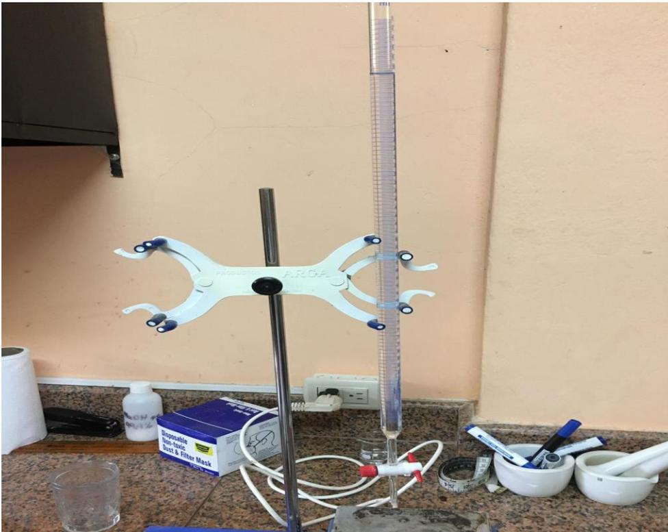
**Figura A. 43. Verter en una bureta la solución de NaOH.**
