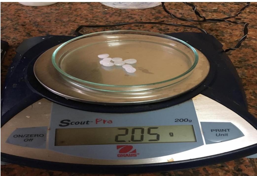
**Figura A. 36. Pesando 2gr de Hidróxido de Sodio (NaOH).**
