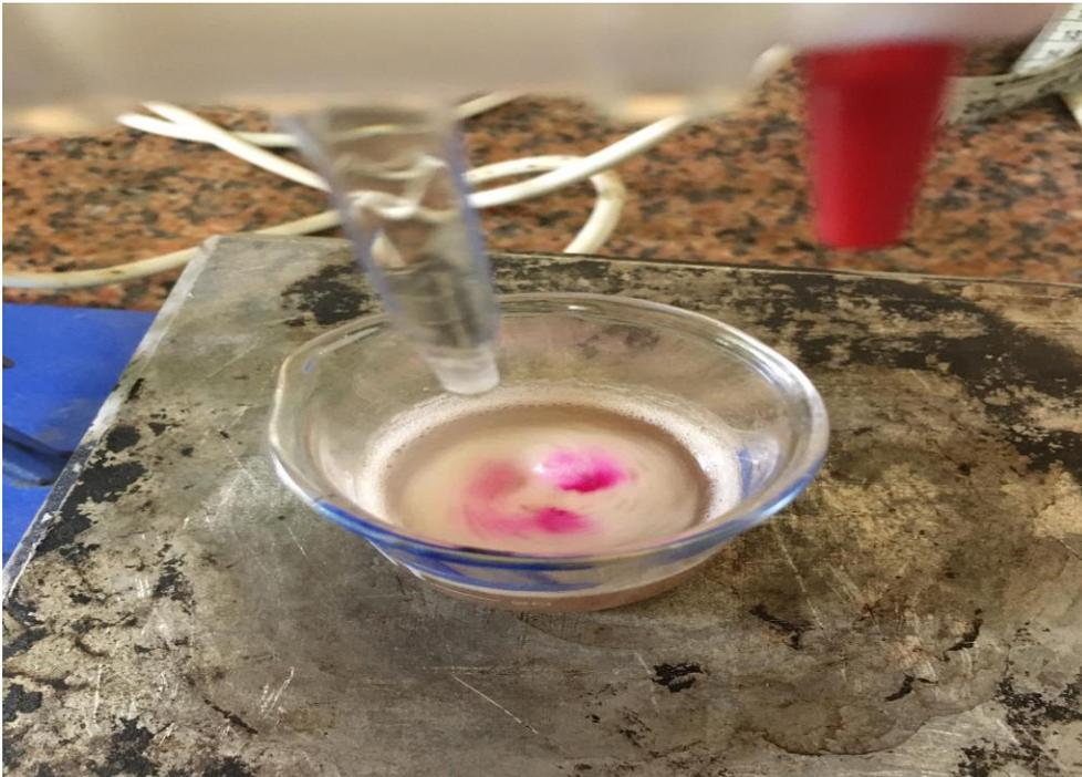
**Figura A. 45. Aplicando la solución de NaOH en cada muestra para identificar la Acidez titulable.**
