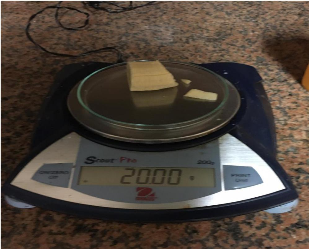
**Figura A. 27. Peso muestra (20gr) en una balanza exacta, para el análisis de los grados Brix.**
