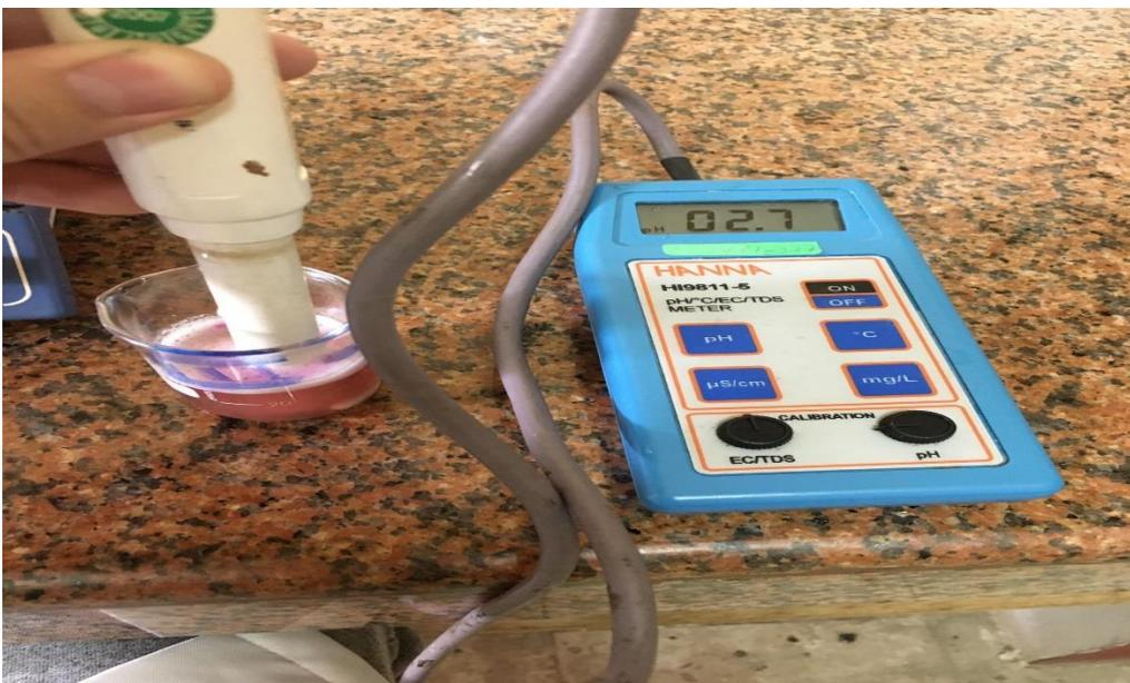
**Figura A. 48. Medir el pH con un pHmetro cada muestra hasta que el numero en la pantalla nos arroje un resultado.**
