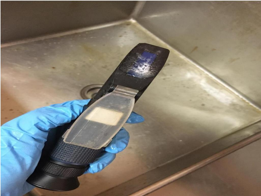
**Figura A. 29. Colocar la muestra en el refractómetro y observar.**
