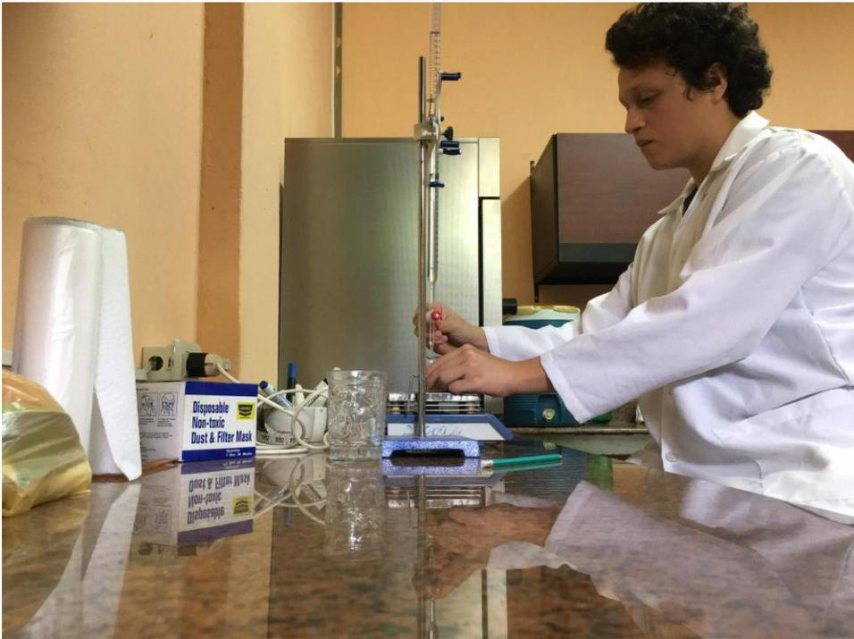
**Figura A. 47. Medir la cantidad que se uso de la solucion de NaOH y anotarla para el cálculo de datos.**
