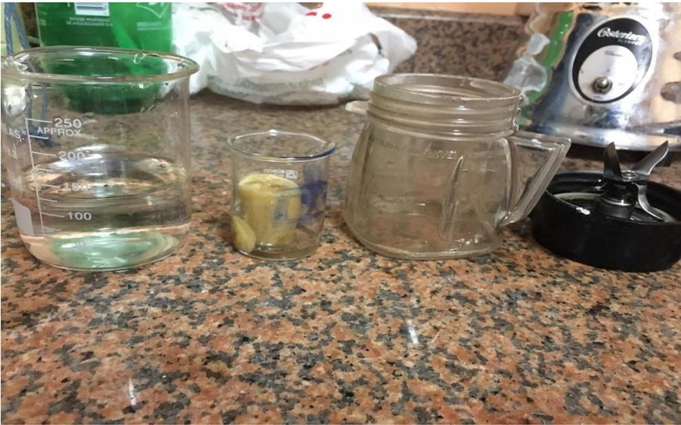
**Figura A. 41.** Serán licuadas las muestras de 20gr de pulpa con 125ml de agua destilada.
