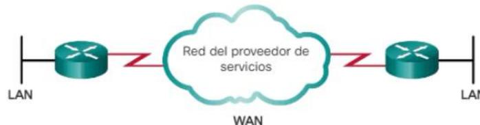
Figura 10 Conexión serial punto a punto
