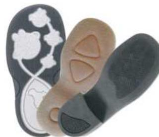
caídas. Existen varios procesos para la fabricación de las mismas, pueden ser inyectadas o moldeadas en una máquina de compresión. En la mayoría de los casos la materia prima esta granulada y es fundida a temperaturas entre los 100 °C y 170 °C para luego ser estampada en moldes fabricados con aluminio, acero o pasta con el diseño de la suela.
