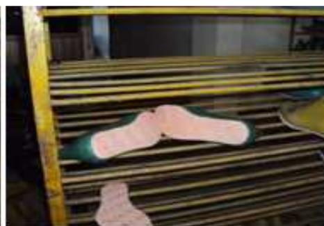
La planta es una fibra de cartón en lámina, la cual una vez suajada (recortada con cuchillas llamadas suajes) se remoja en gasolina para que se ablanden y al secarse endurezca un poco más.
