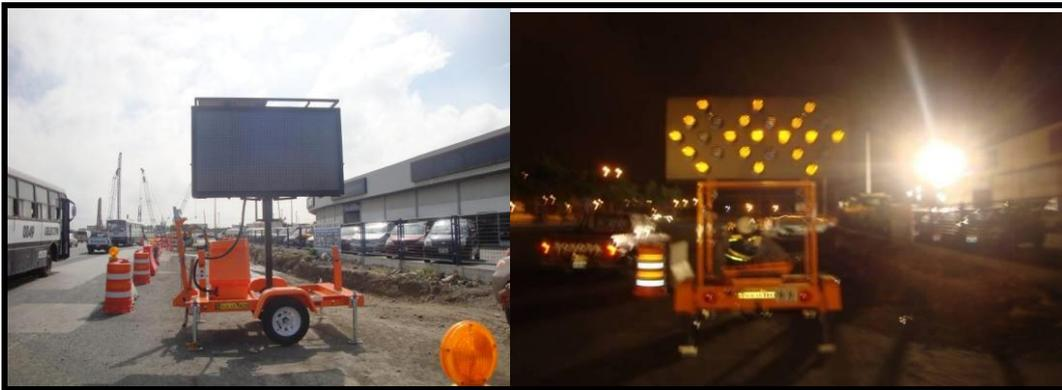
Fig. 26. Panel portátil LEDS de señales de flechas de prevención de (1,22x 2,44)m (Inc. remolque)
