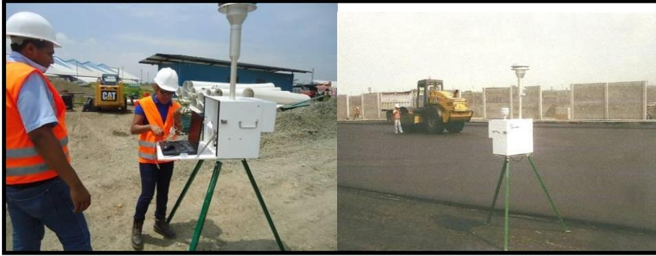
Fig. 6. Ilustración de monitoreos de material particulado.
