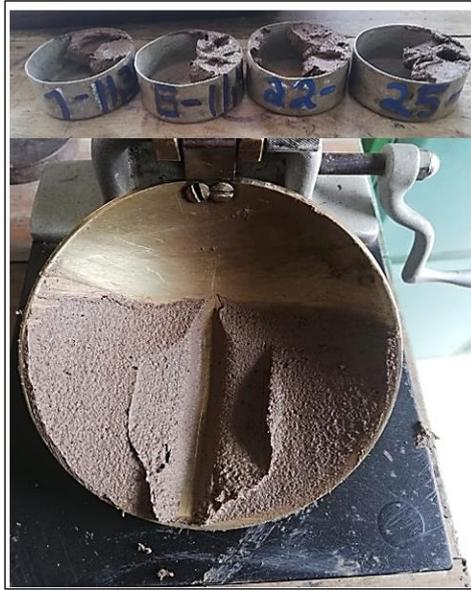
**Ilustración 8:** Ensayo límite líquido.
