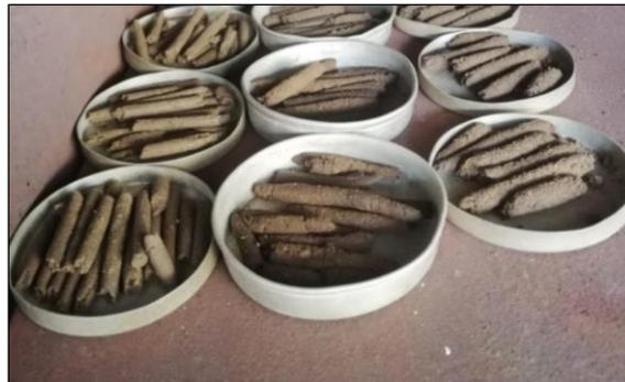
**Ilustración 9:** Ensayo límite plástico.
