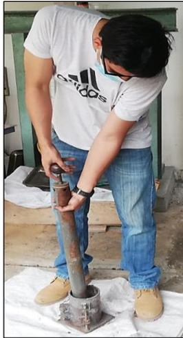
**Ilustración 11:** Ensayo Proctor Modificado.
