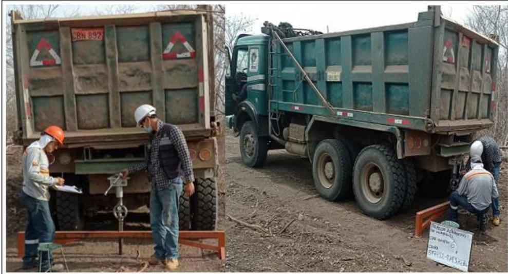
**Ilustración 13:** Equipos para ensayo de CBR in situ.
