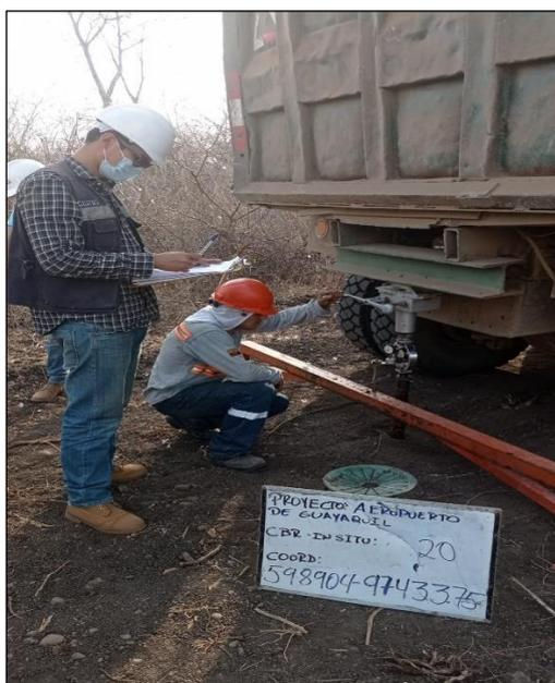
**Ilustración 6:** Ensayo de CBR in situ.
