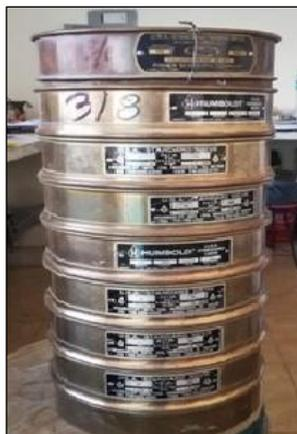
**Ilustración 10:** Tamices para ensayo granulométrico.
