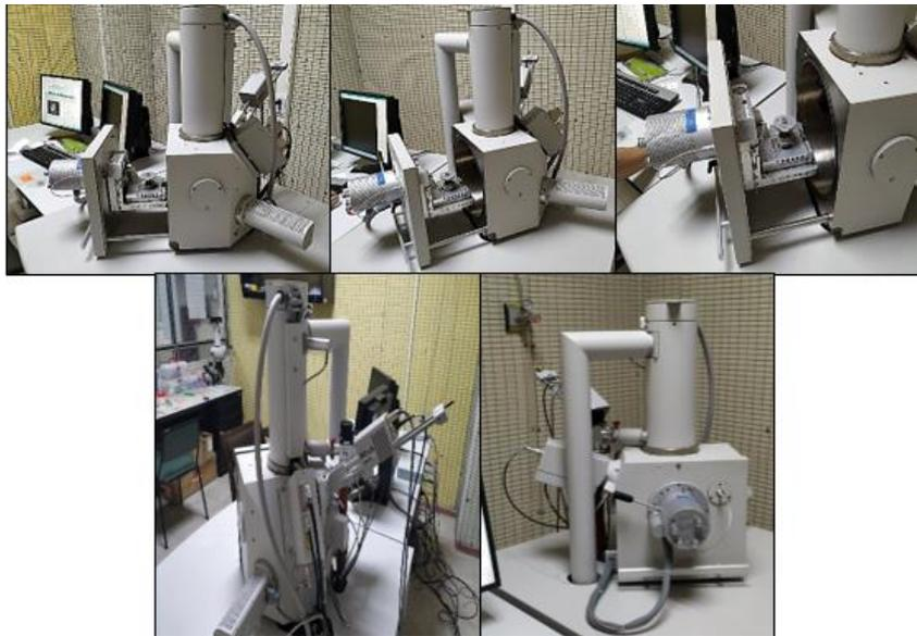
*Figura. Microscopio electrónico de barrido – SEM*
