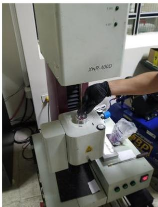
**Figura 20. Plastómetro XNR 400D**
