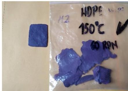
**Figura 18. M2 – Polietileno de alta densidad con 25% de cochinilla (*Dactylopius coccus*) – 150°C x 10 min.**
