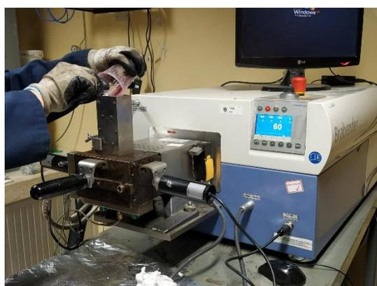
**Figura 17. Mezclador Brabender Plastograph EC Plus.**
