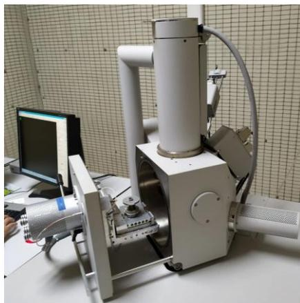
**Figura 22. Microscopia electrónica de barrido – SEM**
