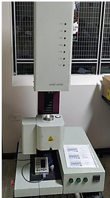
*Figura. Medidor de fluidez XNR – 400D*
