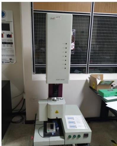
**Figura 21. Plastómetro XNR 400D**
