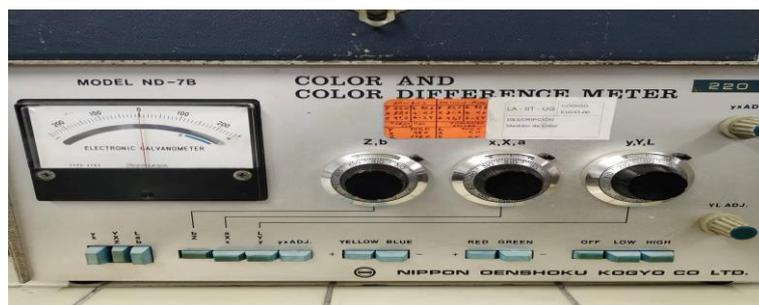
*Figura 25. Equipo Medidor de color Modelo ND – 7B.*
