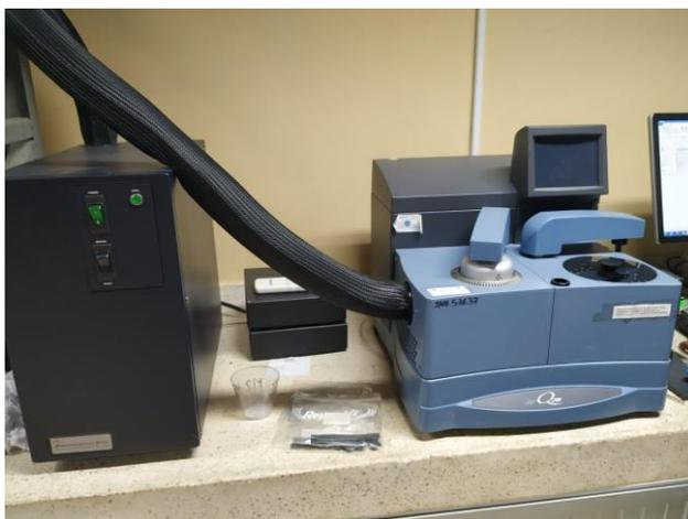
*Figura 14. Analizador Térmico DSC – Q200*
