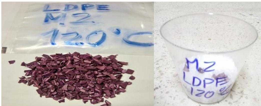
*Figura 24. Masterbatch y mezcla de polietileno de baja densidad (LDPE).*
