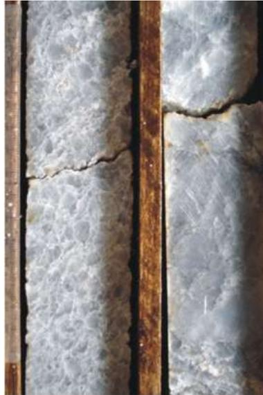
*Figura 21 Sondaje 1 @223m Masivo de Yeso pseudobrechado.*
