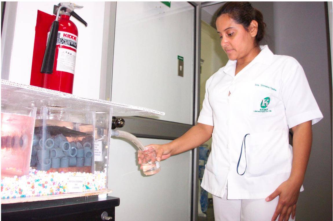
TOMA DE MUESTRA DE AGUA RESIDUAL DESPUES DE PASAR POR EL FILTRO ANAERÓBICO
