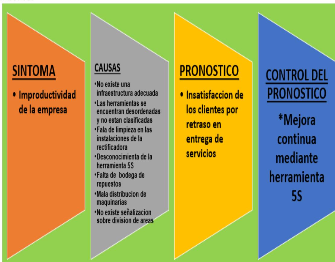
**Figura 10.** Síntoma, causas, pronóstico y control del pronóstico. Información adaptada de Rectificadora Bastidas Robayo. Elaborado por Parrales Mero Wilmer Humberto
