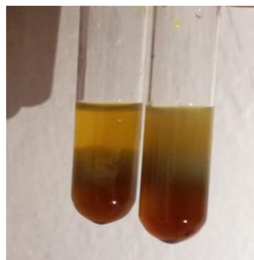
Ensayo de cloruro férrico para determinar compuestos fenólicos
