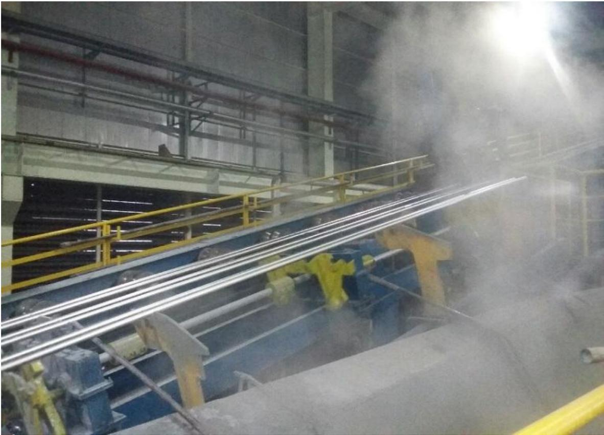
**Figura 16:** Transporte de tubos hacia tina de enfriamiento, 2018. Información tomada en Novacero S.A. Elaborado por el autor
