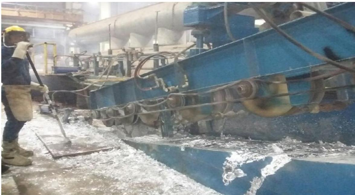
**Figura 13:** Extracción de tubos desde la cuba, 2018. Información tomada en Novacero S.A. Elaborado por el autor
