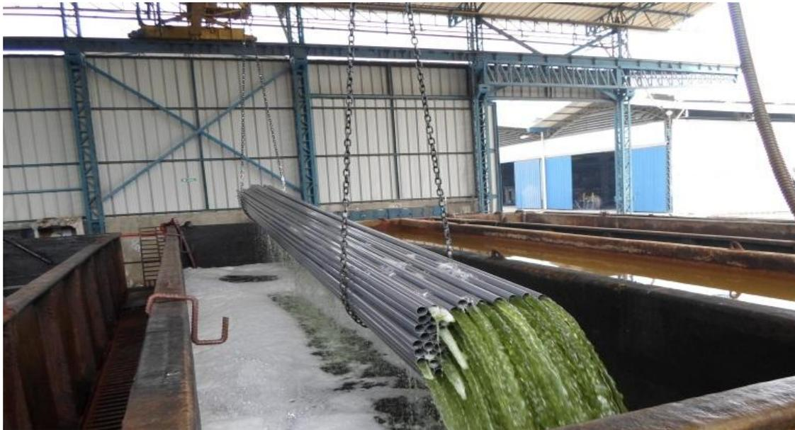
*Figura 1: Decapado A1-A2-A3, 2018. Información tomada en Novacero S.A. Elaborado por el autor*
