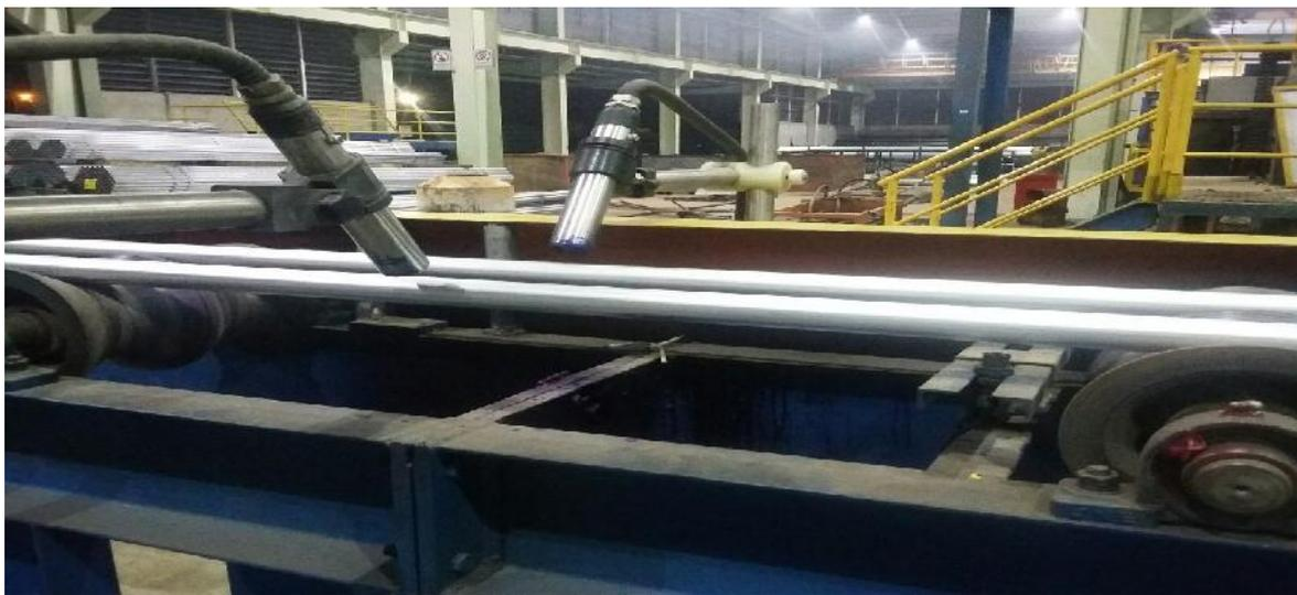
**Figura 17:** Codificación de tubos, 2018. Información tomada en Novacero S.A. Elaborado por el autor
