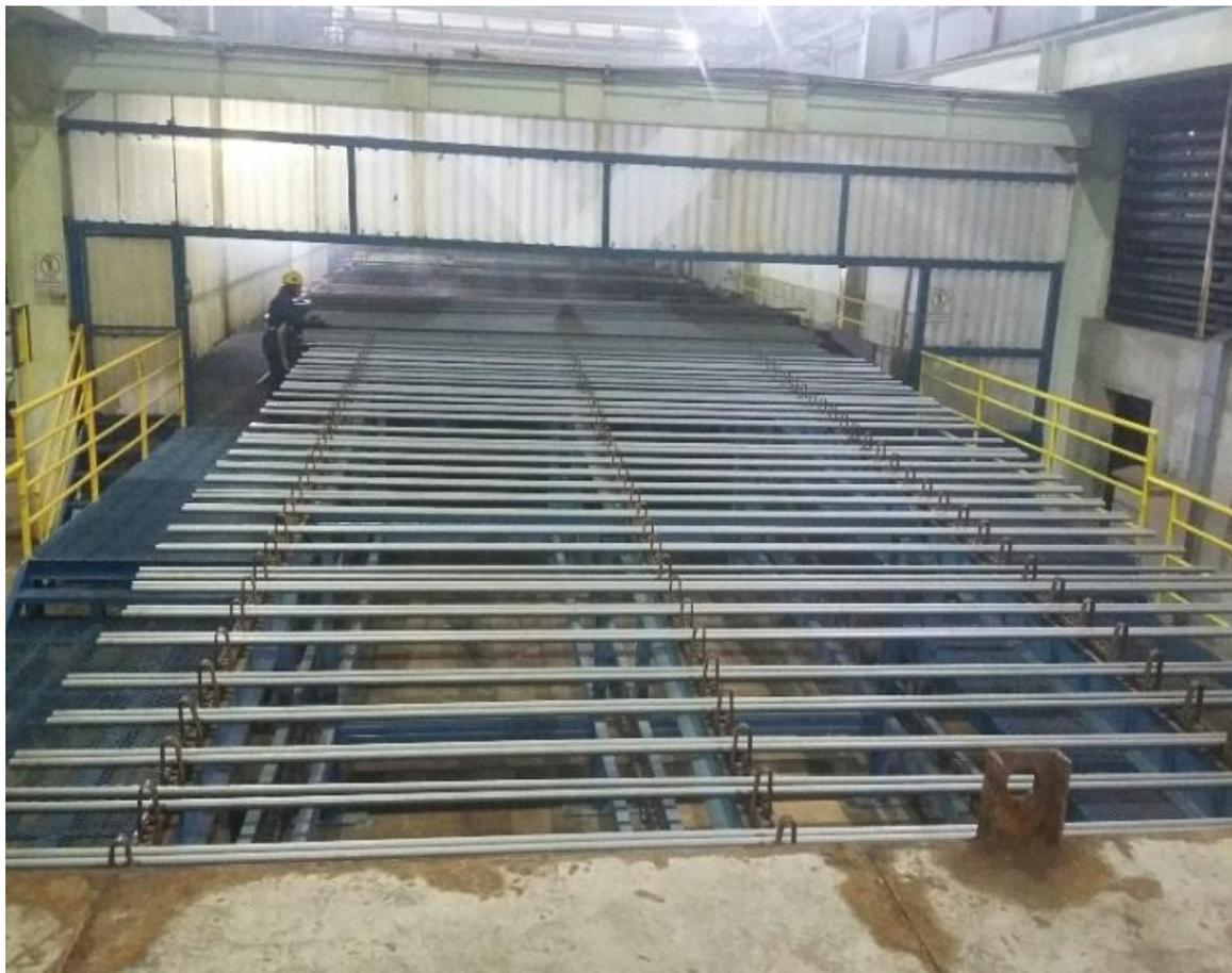
**Figura 12:** Inmersión de tubos hacia la cuba, 2018. Información tomada en Novacero S.A. Elaborado por el autor
