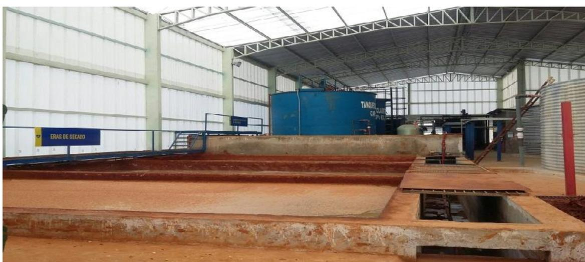
*Figura 6: Sistema de cisternas de lodos residuales, 2018. Información tomada en Novacero S.A. Elaborado por el autor*
