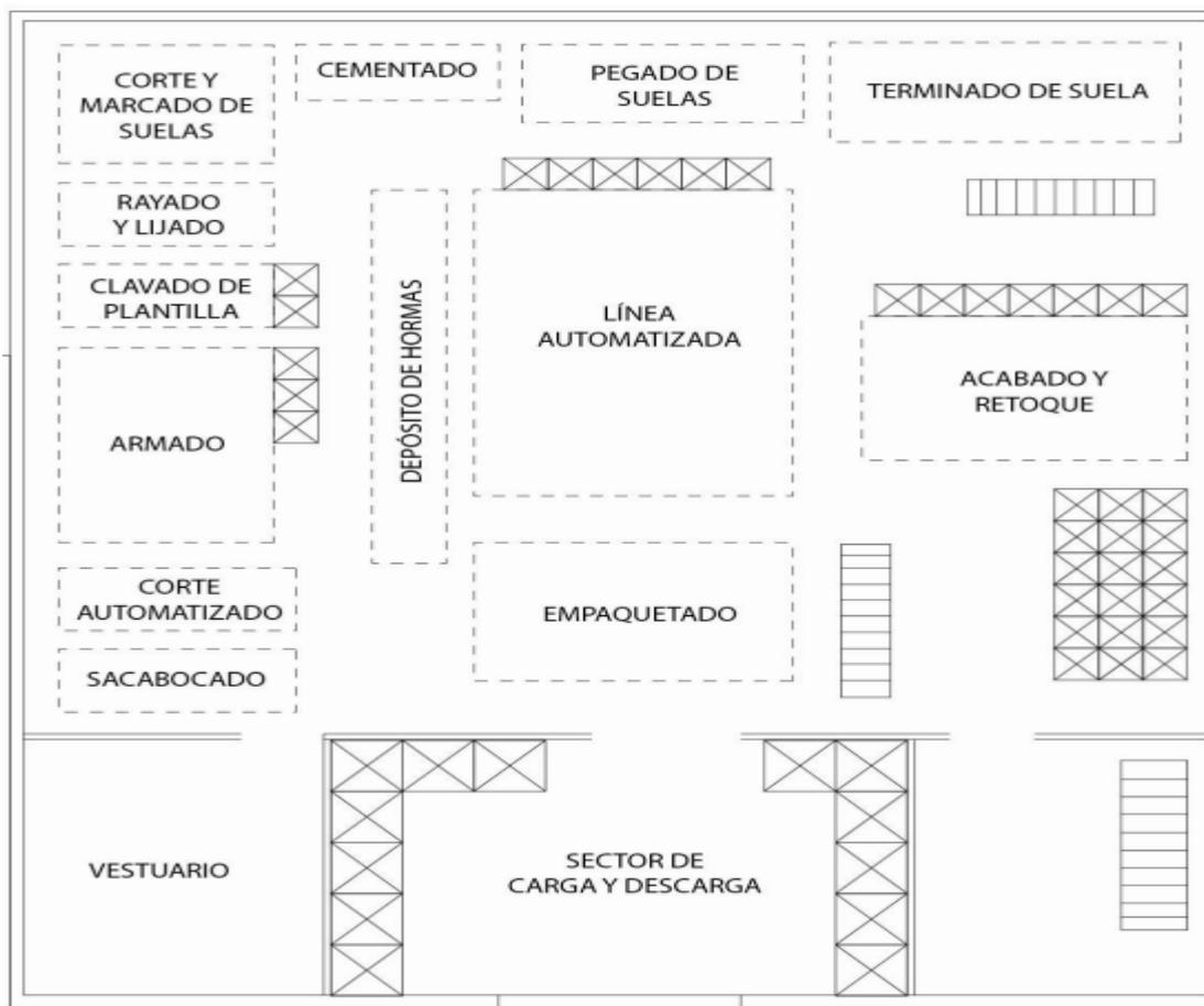
**Figura 1.** Diagrama de planta de una fábrica de calzado. Información tomada de (Boyadjian, 2017). Elaborado por el autor.
