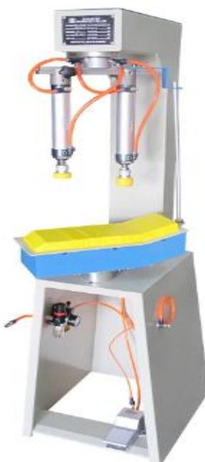
**Figura 31.** Máquina ojalilladora automática. Información tomada de la investigación de campo Elaborado por el autor
