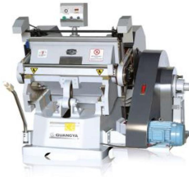
**Figura 30.** Máquina troqueladora automática. Información tomada de la investigación de campo Elaborado por el autor
