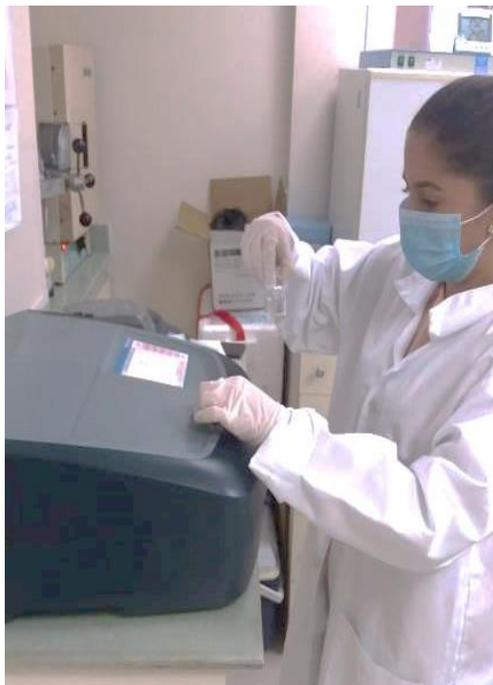
Introducir celda cuadrada con muestra en el espectrofotómetro
