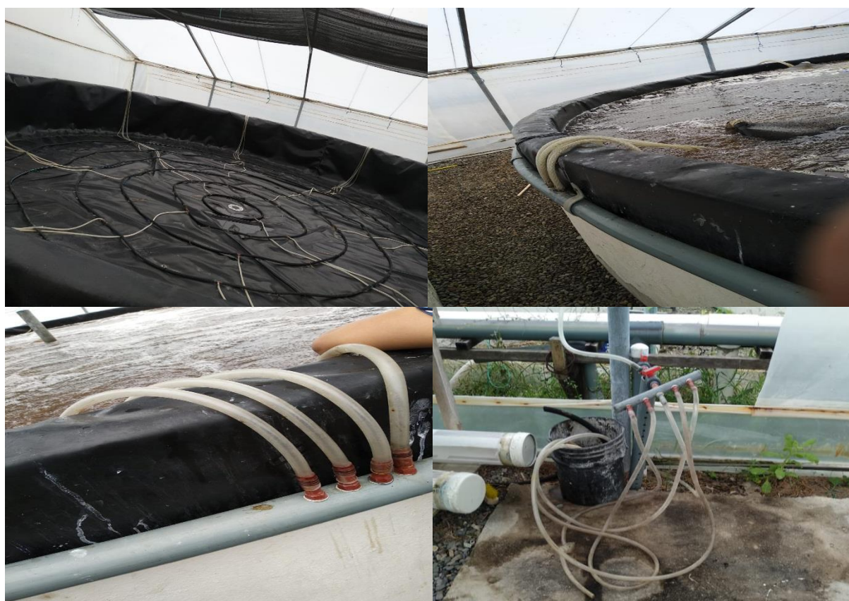
Figura 25. Raceways con sistema de aireación artesanal utilizados en el proceso de cultivo de larvas de camarón de la empresa Safarimar S.A.
